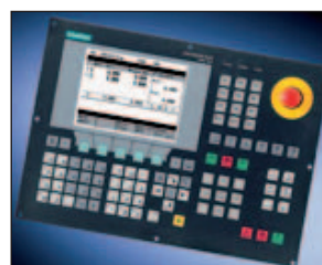
Commande numérique SIEMENS
